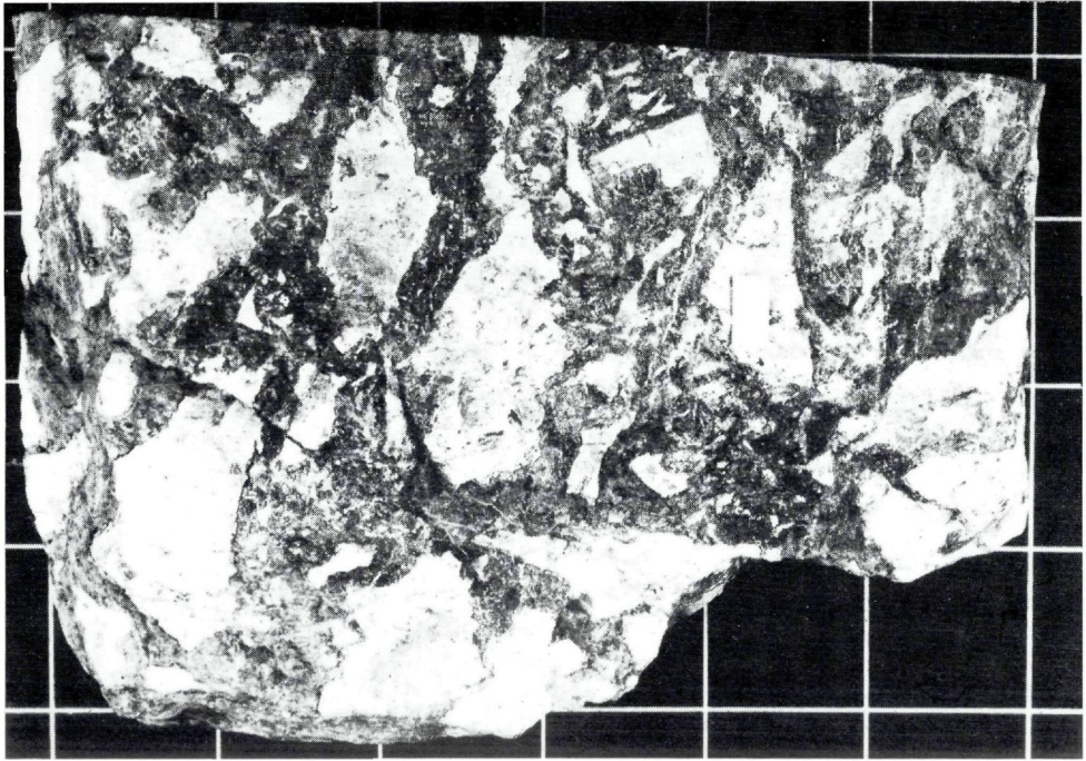
Abb. 4: Syndiagenetische Deformationsbreccie mit wegsamkeitsbevorzugter Mineralisation im Fugennetz. Weiße bis lichtgraue Fragmente: Alpiner Muschelkalk; dunkel- bis schwarzgraue Fugenfüllung: Schalenblende, Bleiglanz und Pyrit. Bergbau St. Veit (Ungeschliffenes Handstück; Marke 10 x 5 mm).
